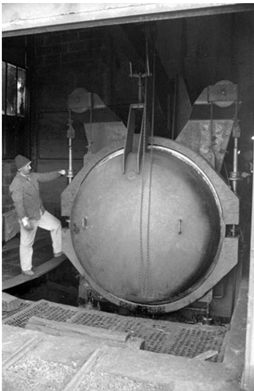
Fermeture de l'autoclave.
