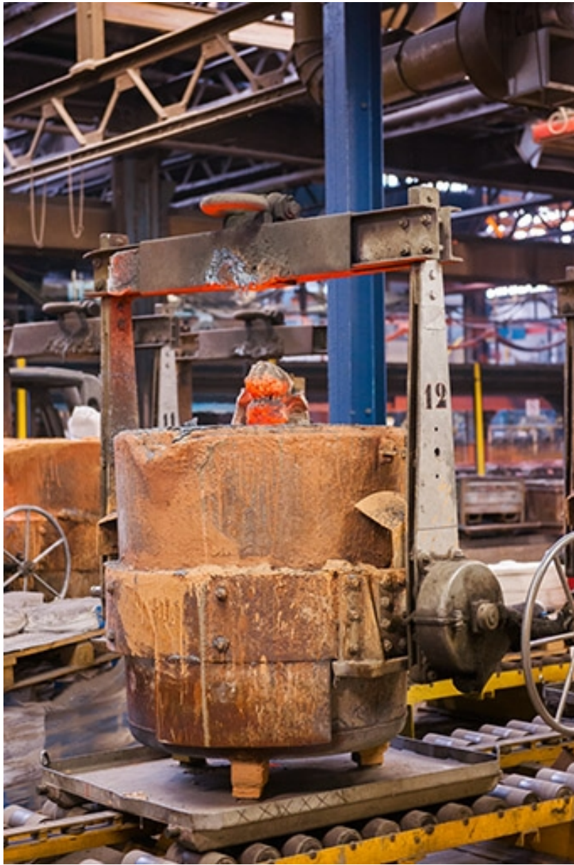
Poche de coulée avant réfection.
