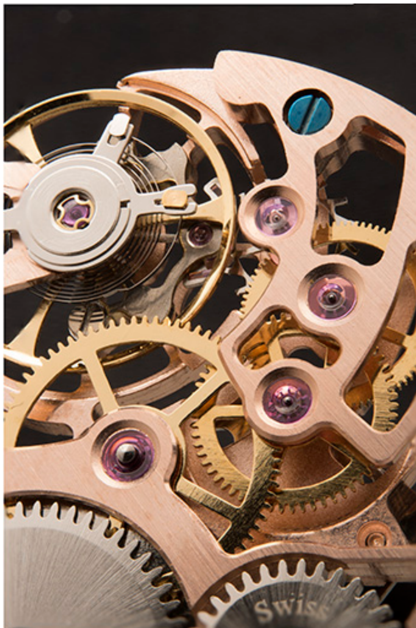
Mouvement rose, détail côté fond : amortisseur de chocs et rouage.
