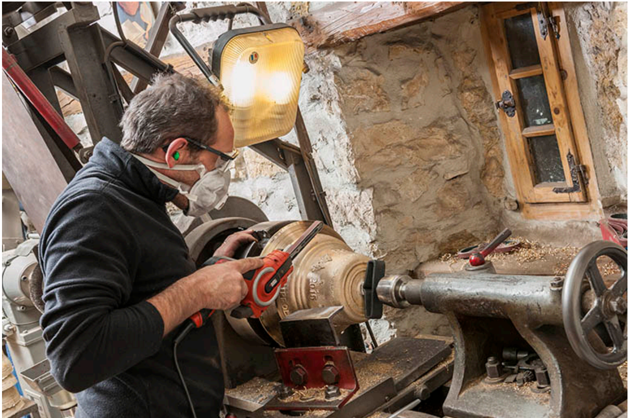
Poste de tournage (meulage) (1).
