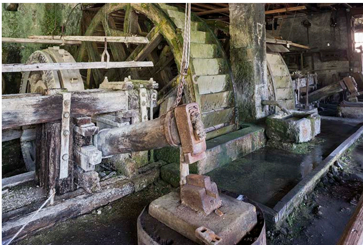
Usine de taillanderie Philibert, Nans-sous-Sainte-Anne : martinets et leurs roues motrices.
