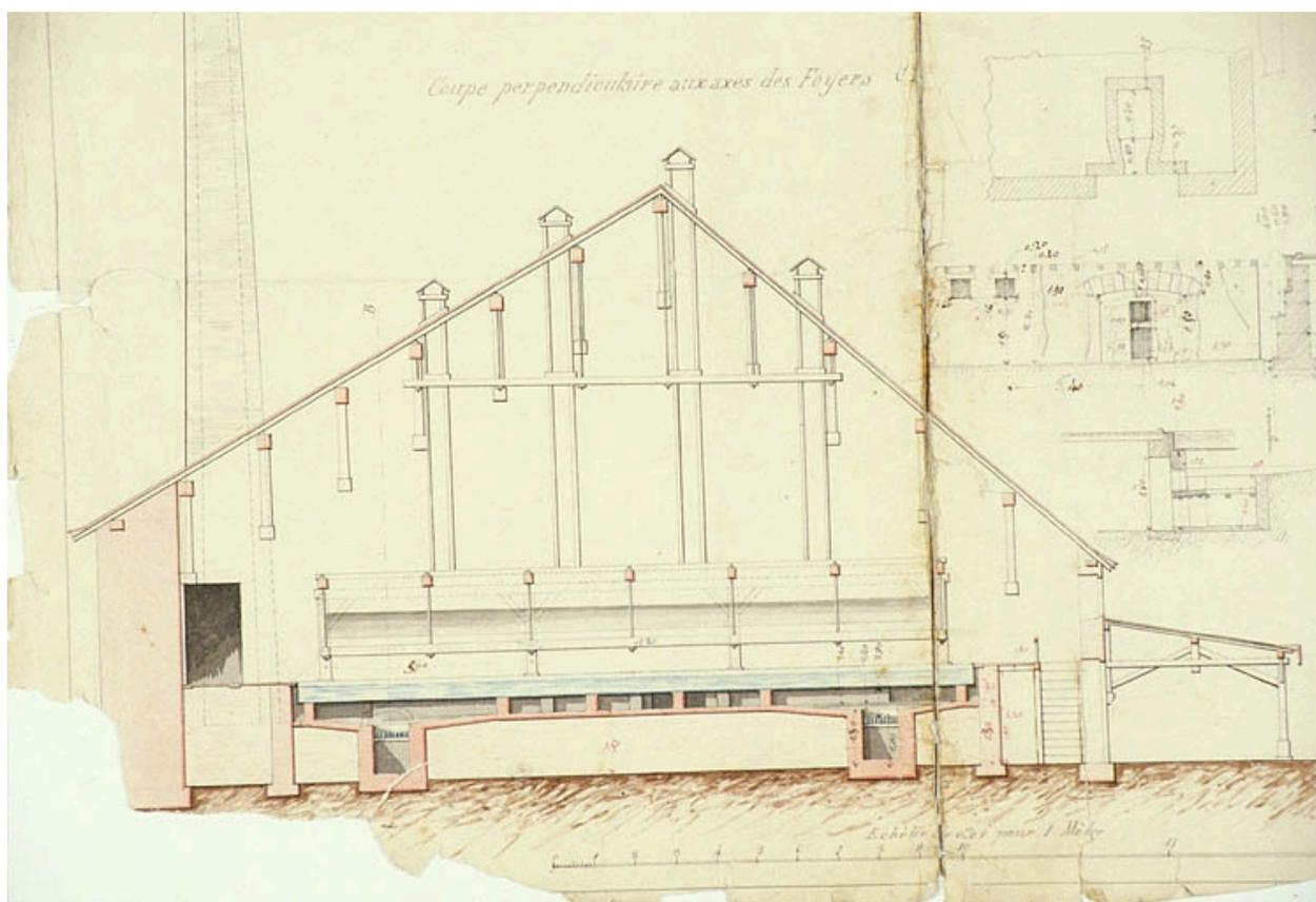
Saline de Salins. Etablissement de deux nouvelles Poêles. Poêle n° 5 [détail : coupe perpendiculaire aux axes des foyers].
