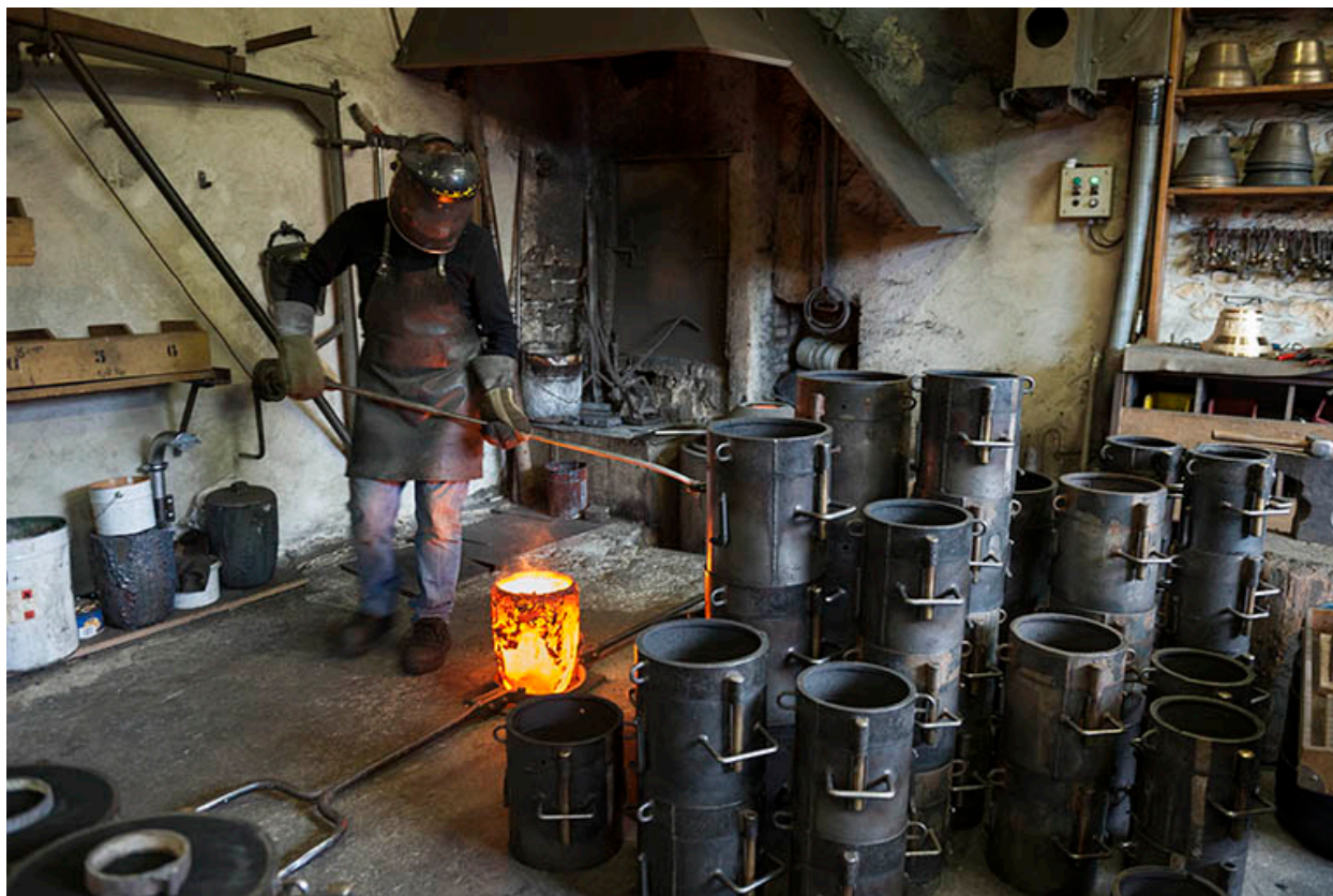
Creuset devant les châssis.
