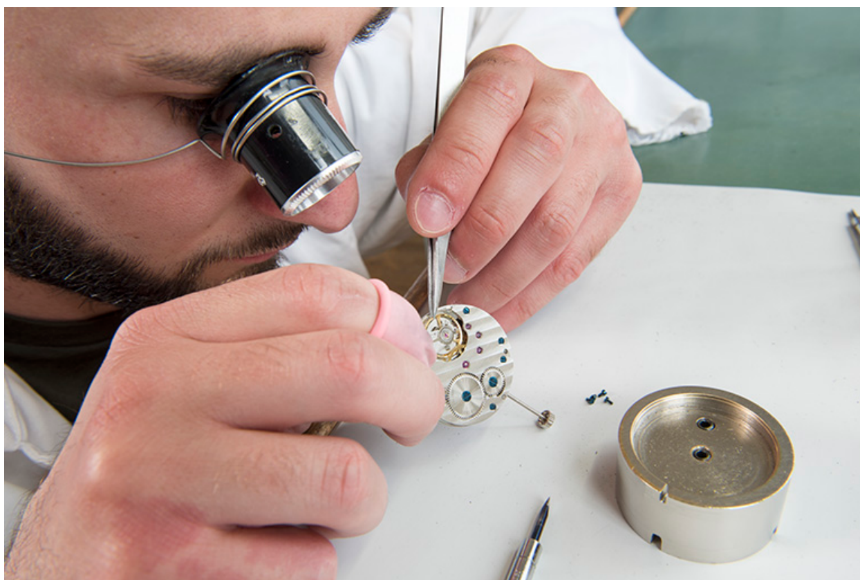
Horloger à l'établi : assemblage d'une montre.
