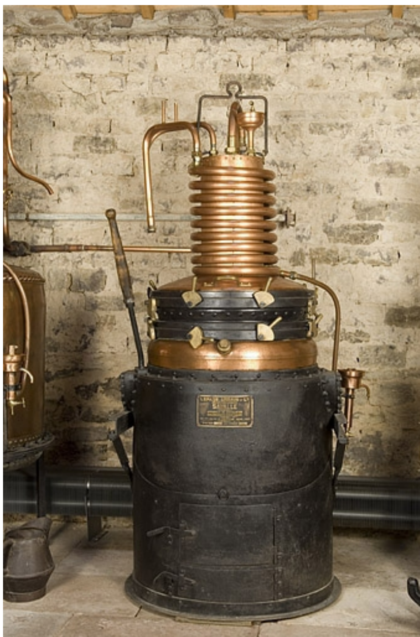
Alambic à vapeur Lepage, Urbain et Cie, provenant de la distillerie Lemer cier (Prédurupt).
