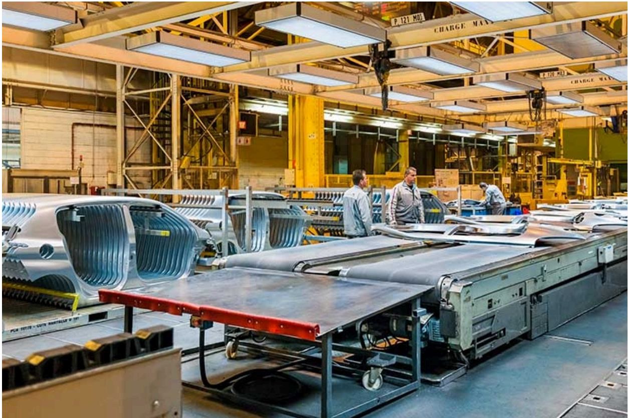
Atelier d'emboutissage. Rangement des côtés de caisse en sortie de presse.
