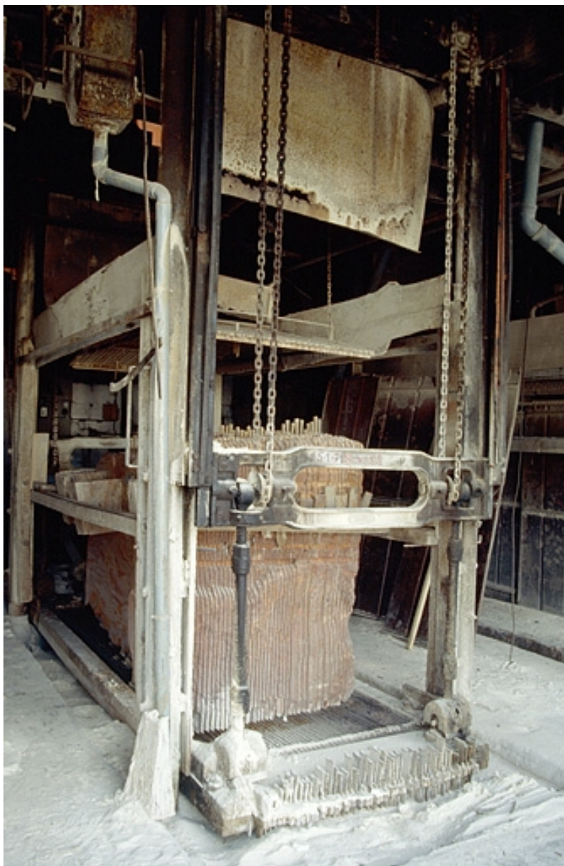
Usine de taille de matériaux de construction Célard, à Saint-Amour : l'un des sept châssis de scie multilames.
