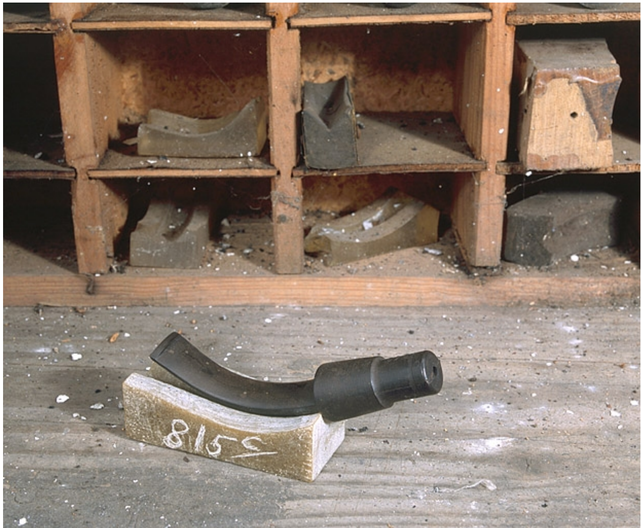
Tuyau en ébonite dans son marbre.
