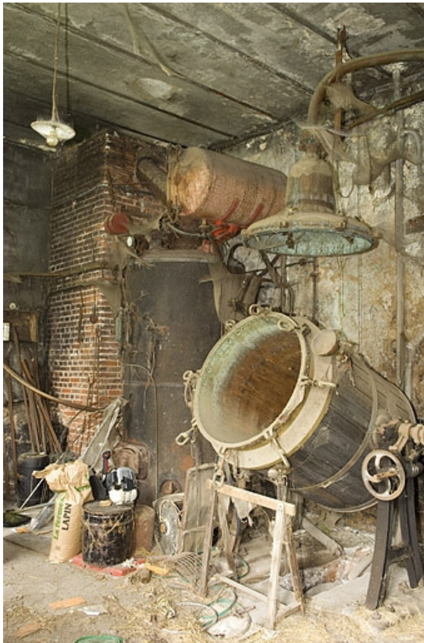
Atelier de distillation : base de la cheminée, chaudière et alambic Egrot et Grangé.
