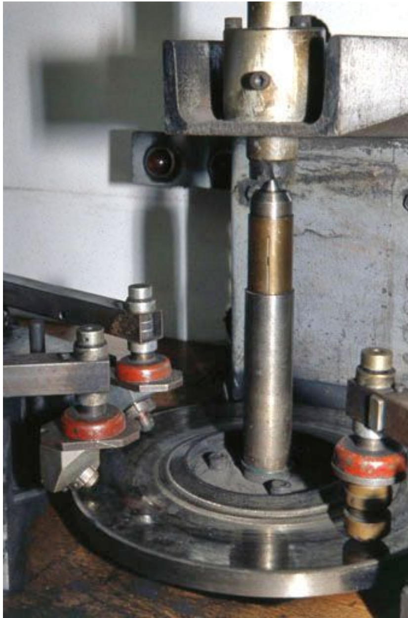
Tête des pinces mécaniques (tenailles de lapidaire) et meule.
