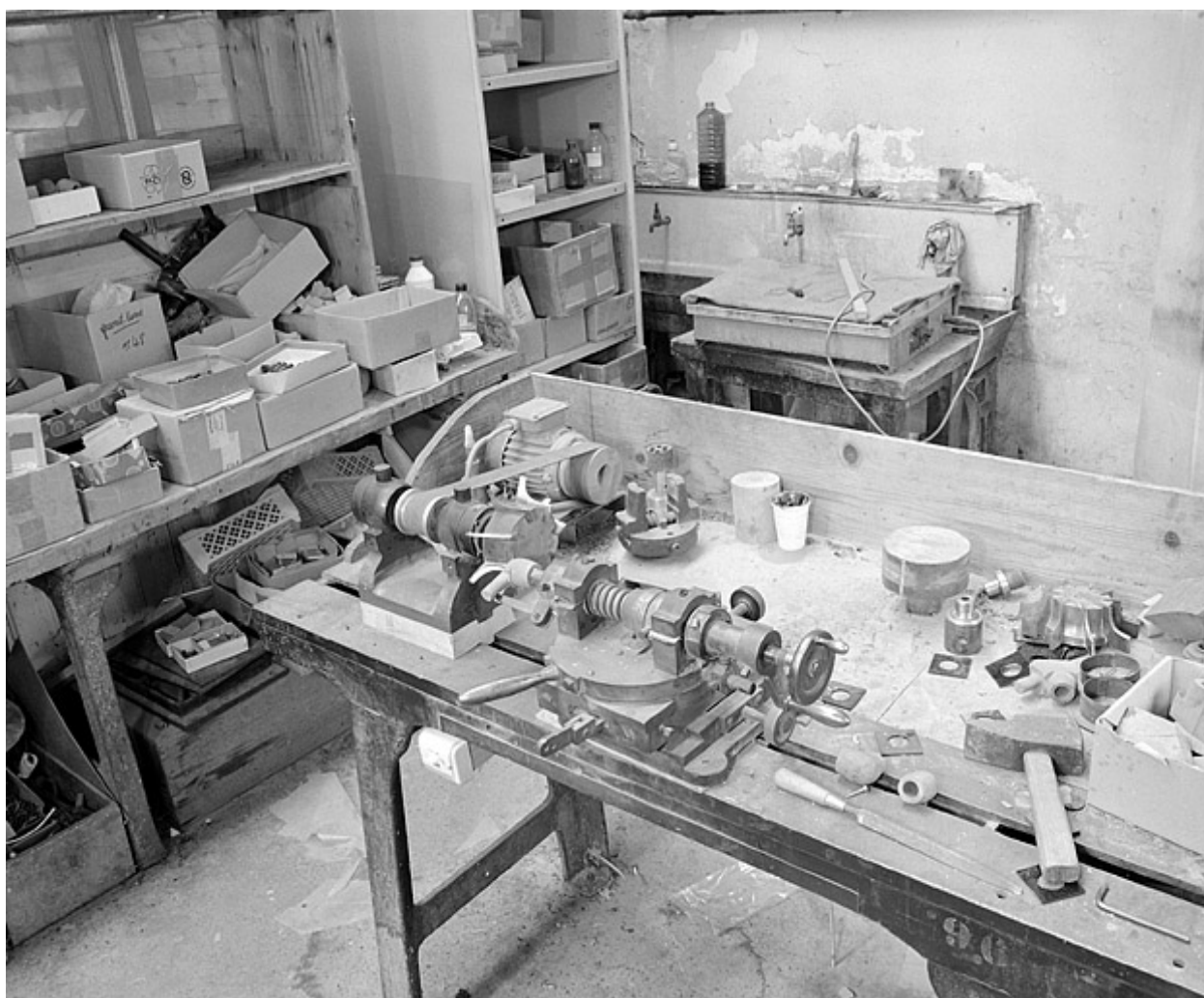
Vue d'ensemble de l'arrondisseur (atelier de finissage).
