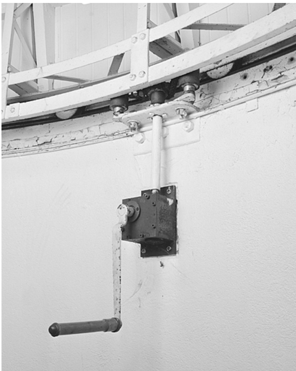
Système de rotation du dôme : manivelle, pignon denté entre deux galets et chaîne d'entraînement.
