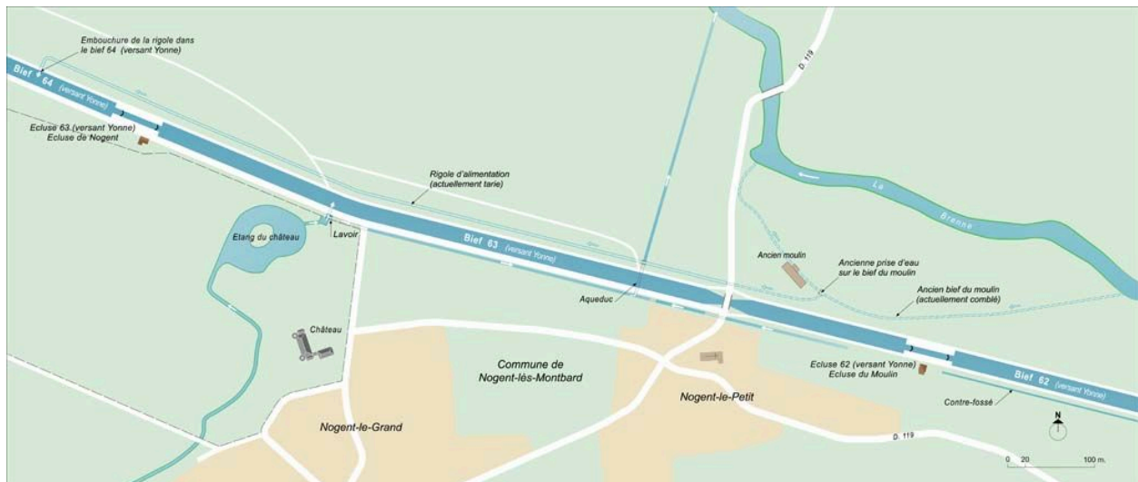
Plan schématique du système hydraulique des biefs 62, 63 et 64 du versant Yonne.
