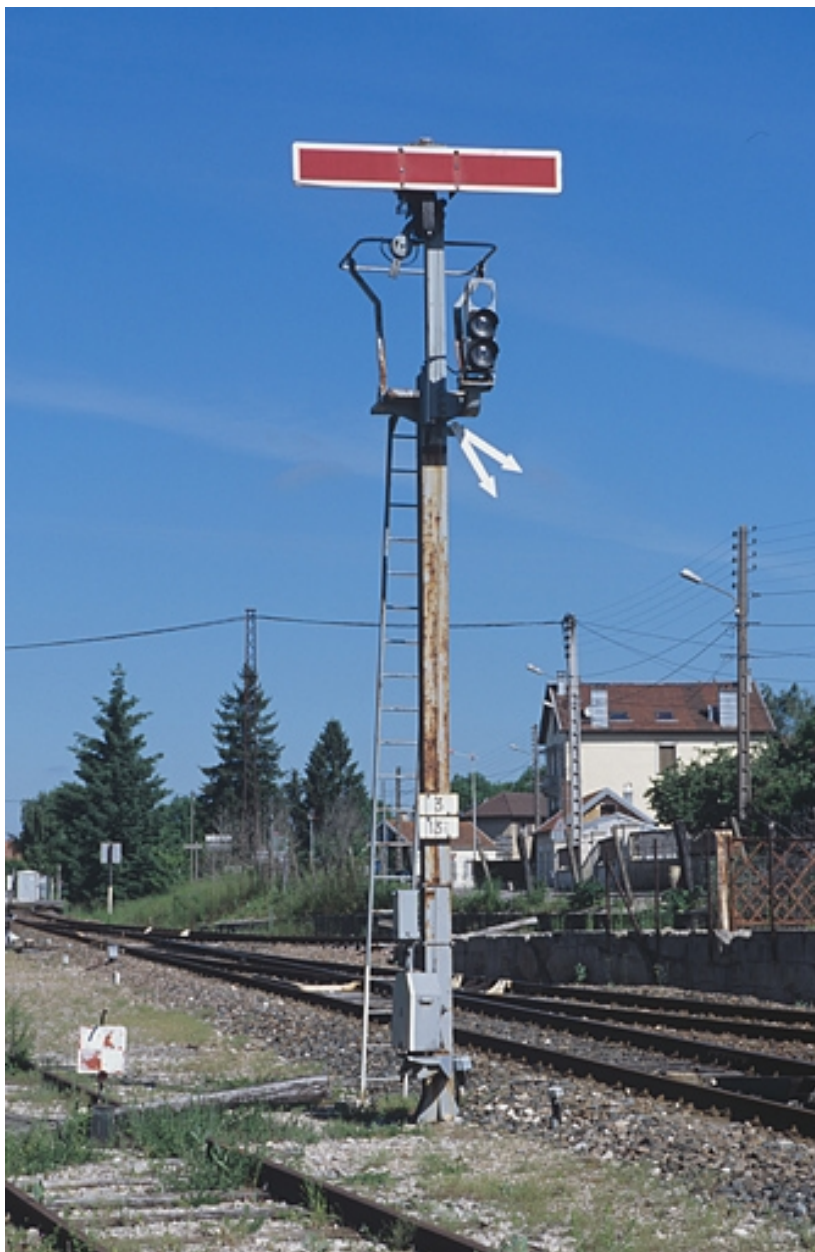
Gare de Champagnole : sémaphore côté Andelot-en-Montagne : vue d'ensemble, en position fermée.
