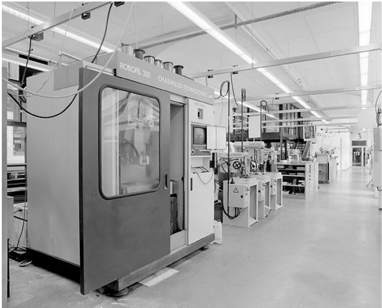
Bâtiment B, atelier de mécanique : machine d'usinage par électroérosion à fil. Machine Robofil 300, de la société Agie Charmilles.
