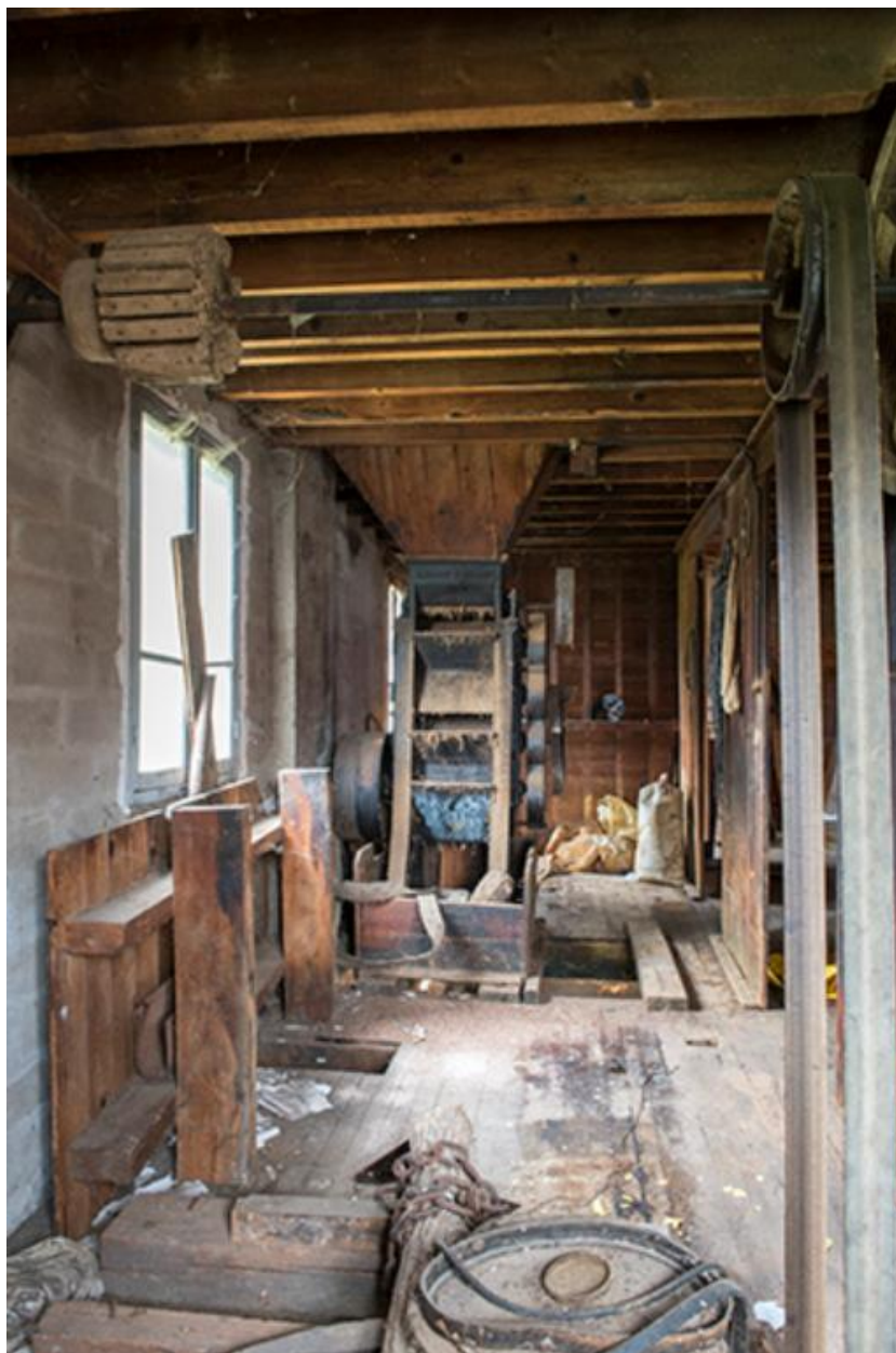
Vue du système de poulie et courroie et de trémie et broyeur à grains, au premier étage
