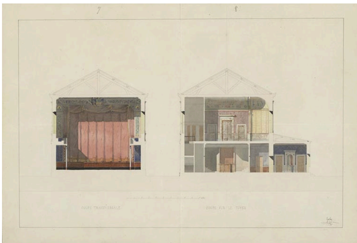
7. Coupe transversale [et] 8. Coupe sur le foyer. [Coupes et élévations par Grosley du théâtre projeté à Semur-en-Auxois]. S.d. [1843 ?].
