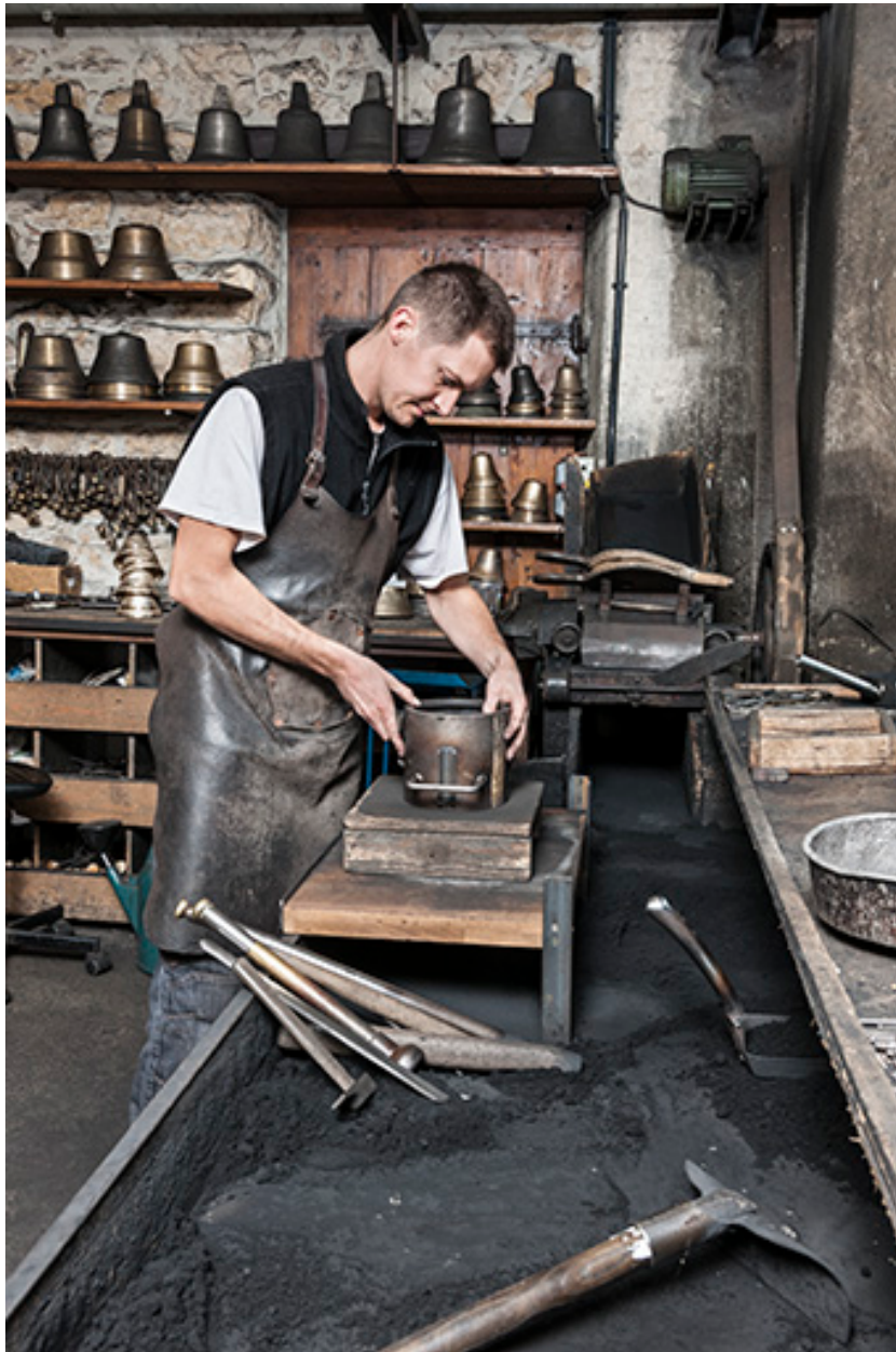
Moulage. Pose du châssis.
