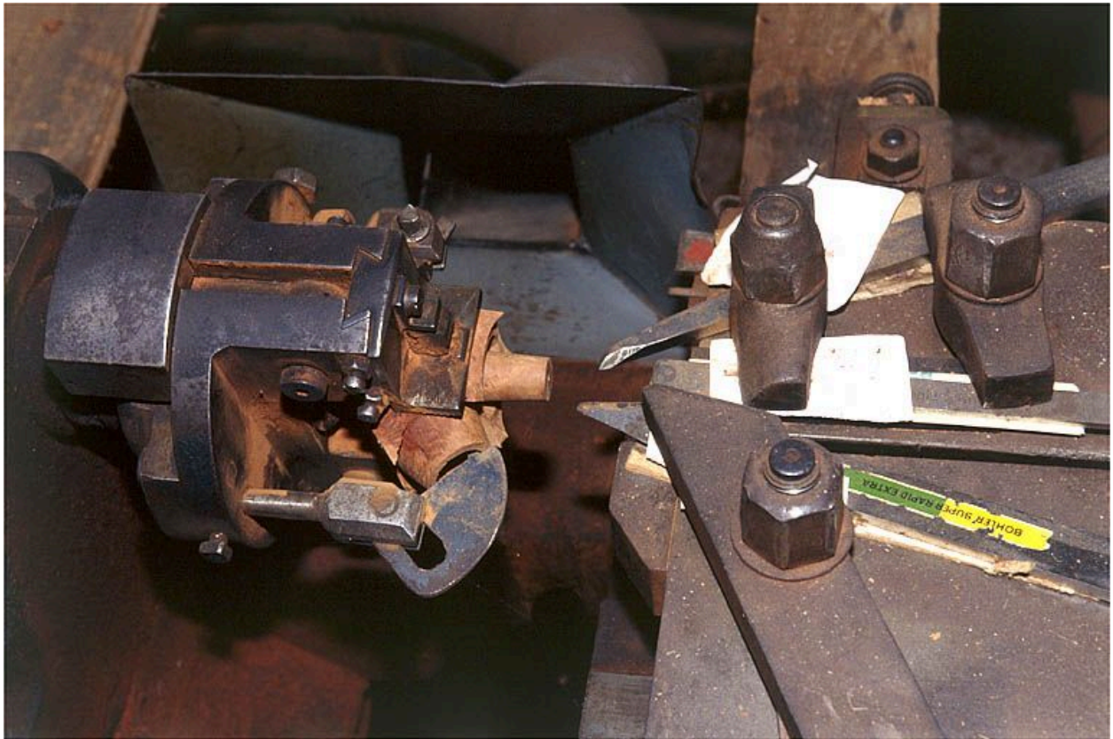
Vue rapprochée du mandrin gueule de loup et des outils.
