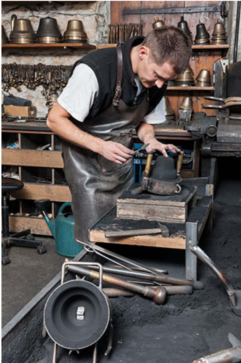
Moulage. Finition (perçement d'orifices pour l'attache du battant).
