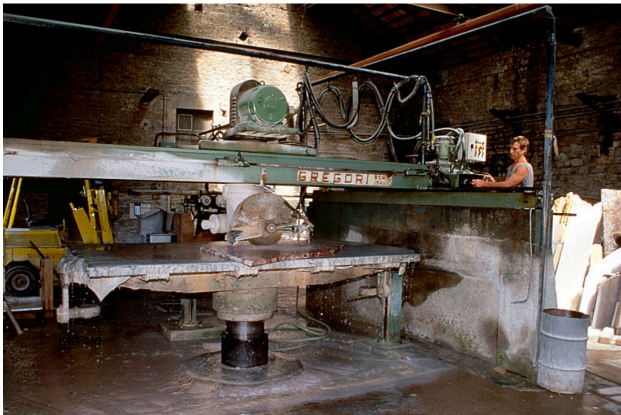
Usine de taille de matériaux de construction Yelmini Artaud, à Balanod : débiteuse Gregori.
