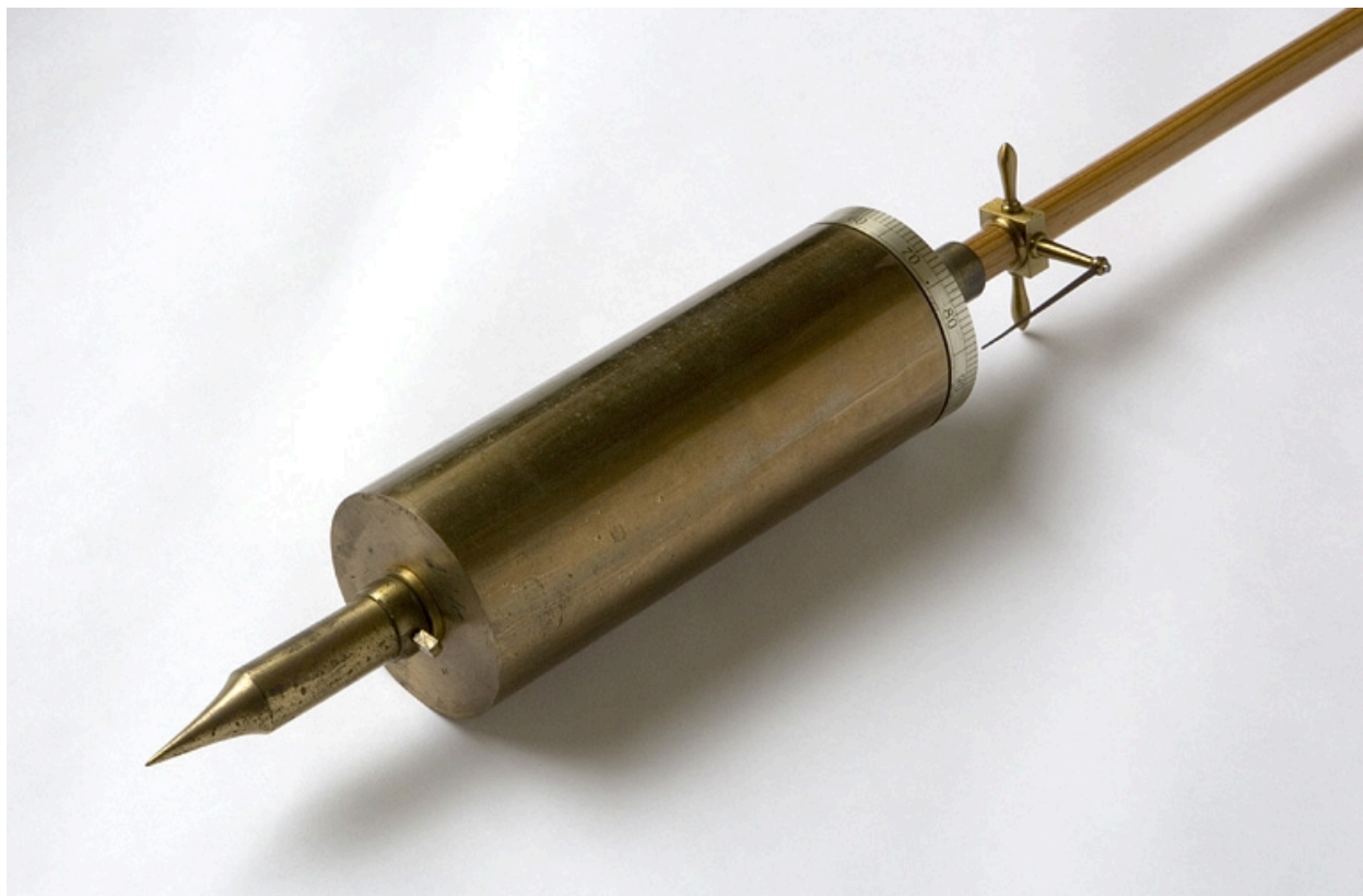
Balancier d'une horloge, avec système de réglage.
