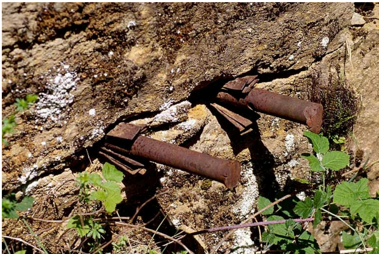
Carrière des Carrats, à Graye-et-Charnay : détail de coins encore en place dans le front de taille.
