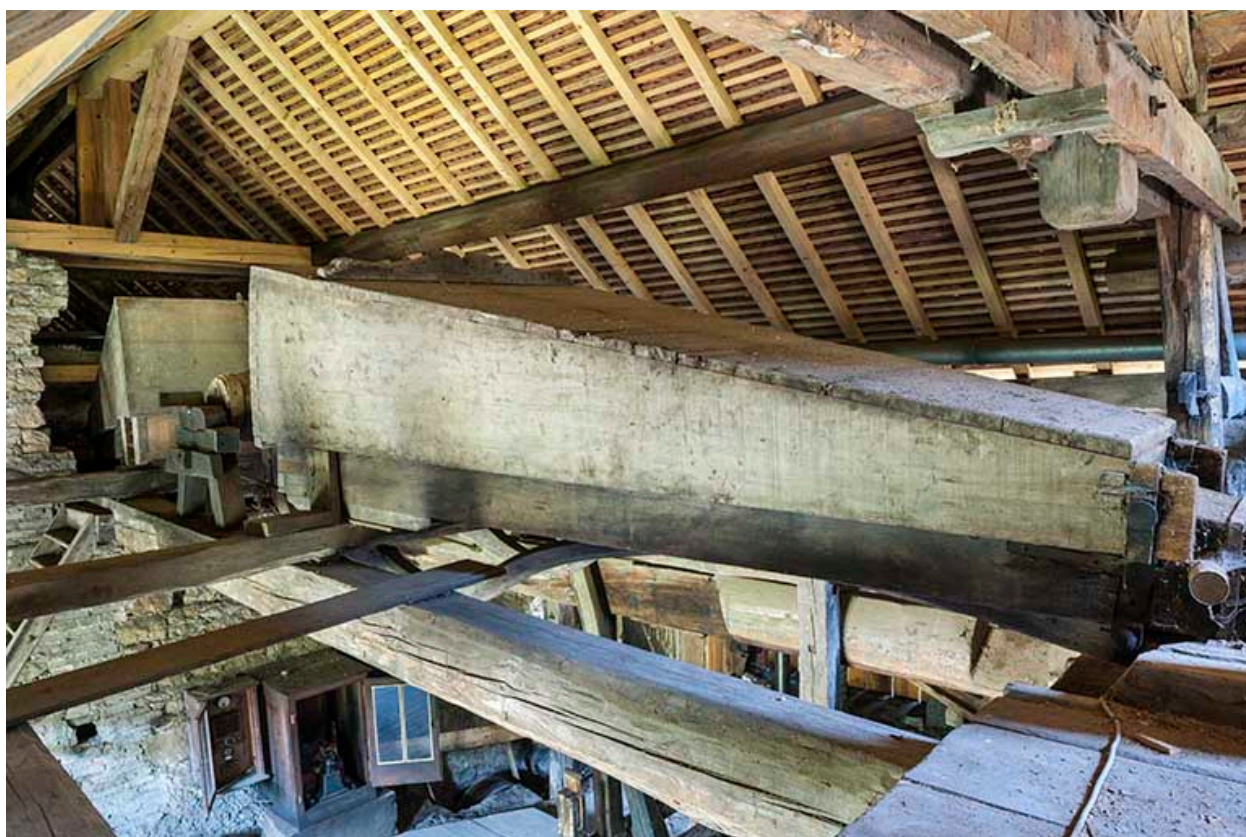
Usine de taillanderie Philibert, Nans-sous-Sainte-Anne : machine soufflante.
