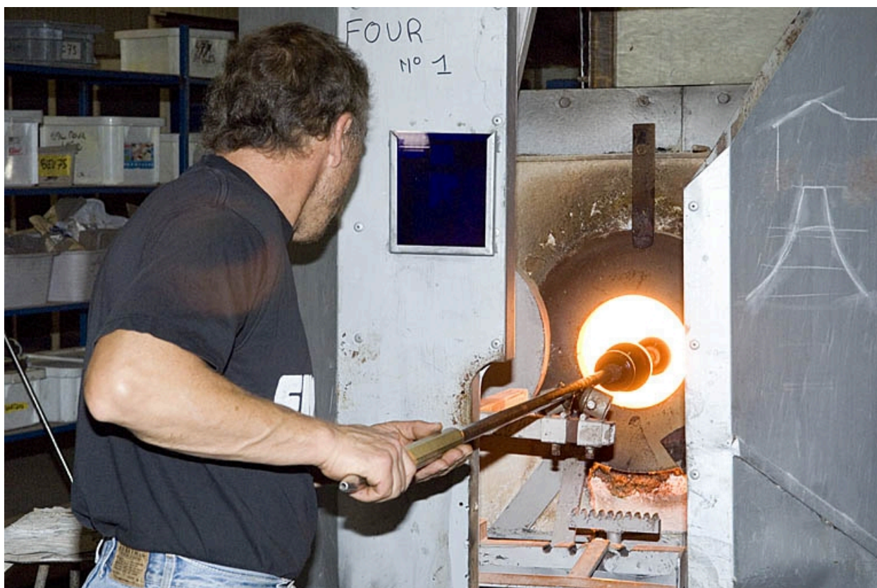
Verrerie de la Rochère : four à réchauffer.
