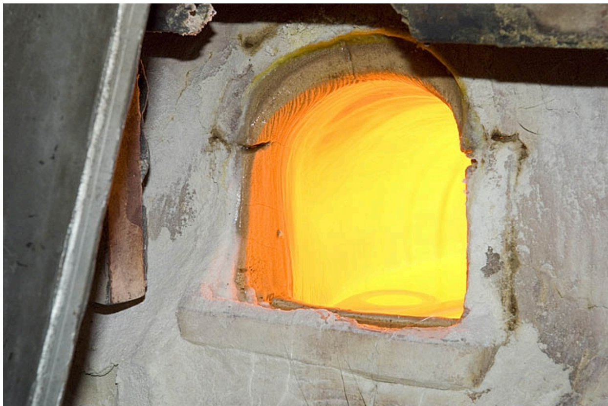
Verrerie de la Rochère : ouverture du four à pots (ouvreau).
