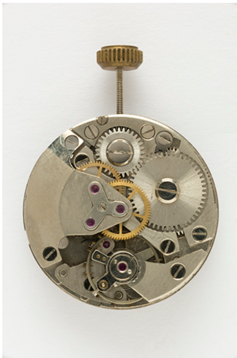
Mouvement Parrenin HP 90 : face côté ponts.
