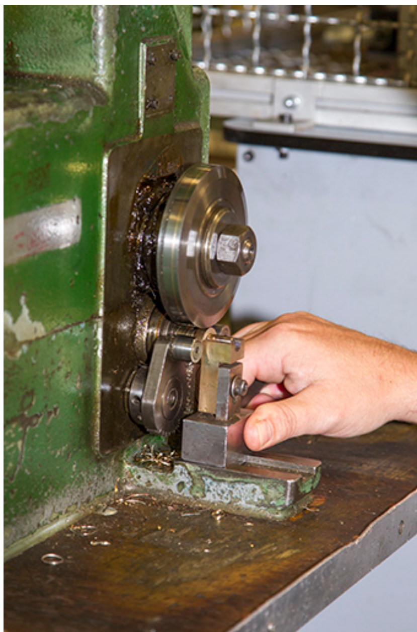
Usinage : laminage de la rondelle (vue rapprochée).
