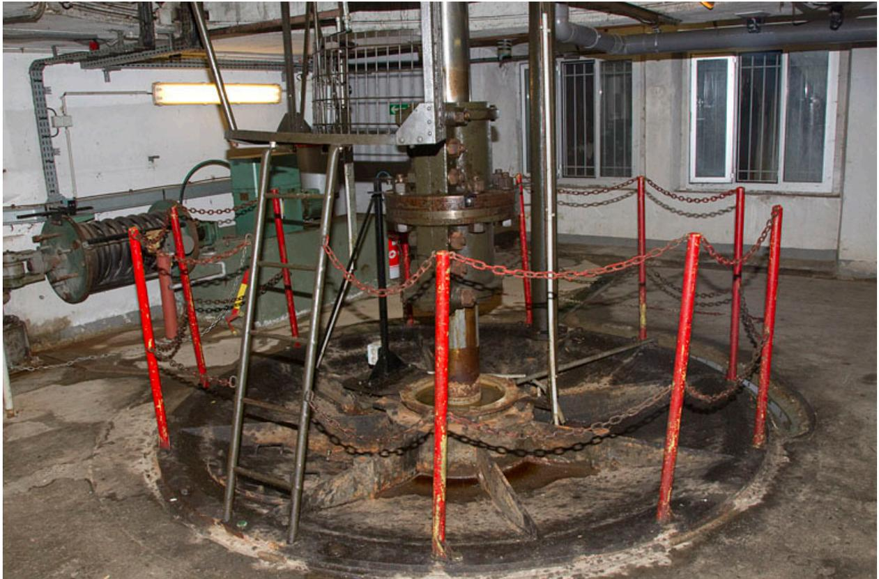
Partie supérieure d'une turbine et arbre de transmission vertical.
