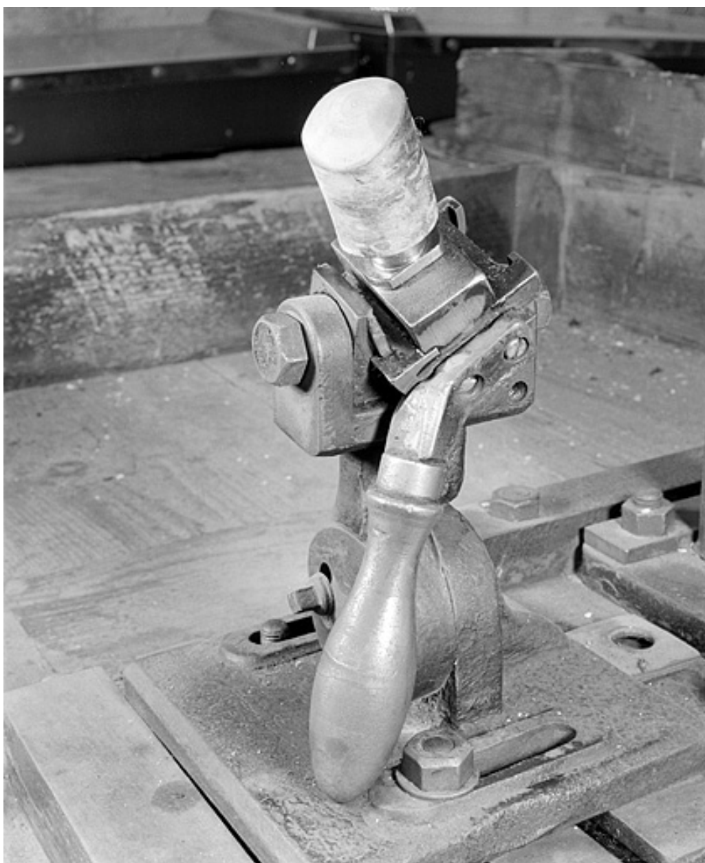
Fourneau enfoncé sur le culot amovible. Vue de trois quarts droite.
