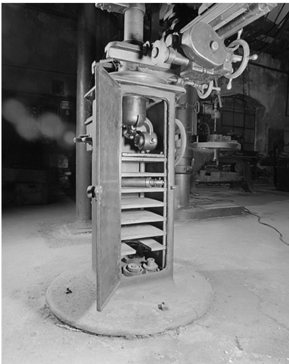
Détail du double système de commande manuelle.
