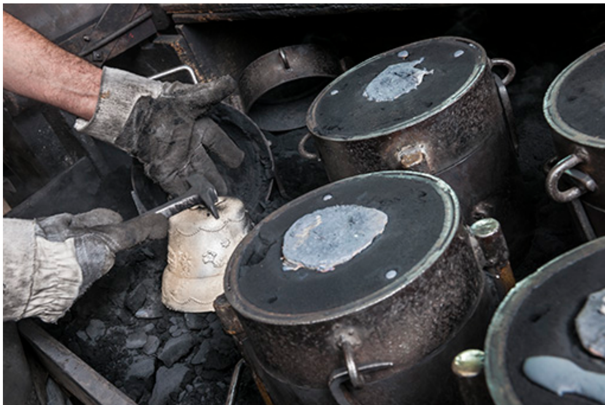
Démoulage. Extraction de la cloche (2).
