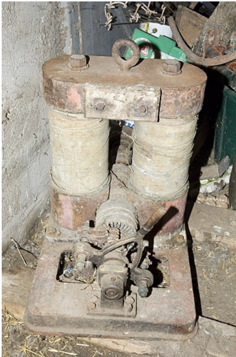
Moteur électrique Edison. Vue de face.
