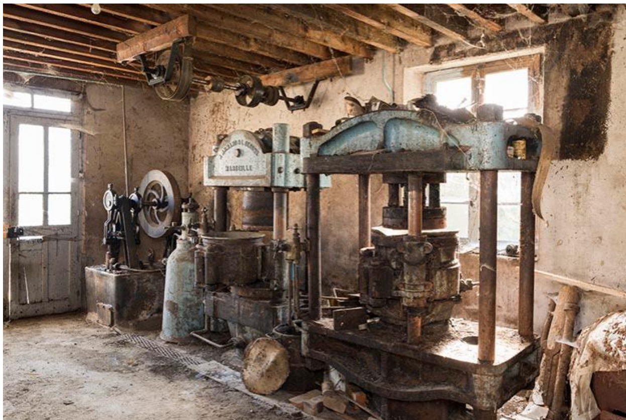
Vue des machines du rez-de-chaussée: pompe hydraulique, régulateur et deux presses hydrauliques
