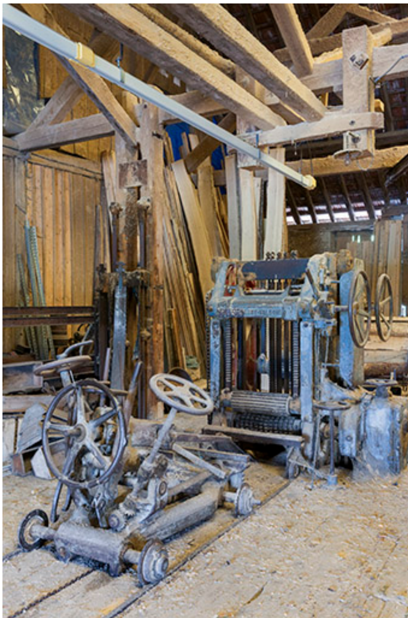
Châssis multilame Socolest (scierie Thiébaud, Labergement-Sainte-Marie).
