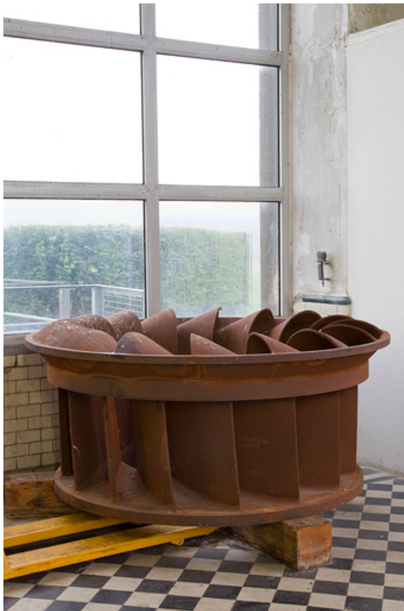
Centrale de la Prétière : turbine Francis déposée.
