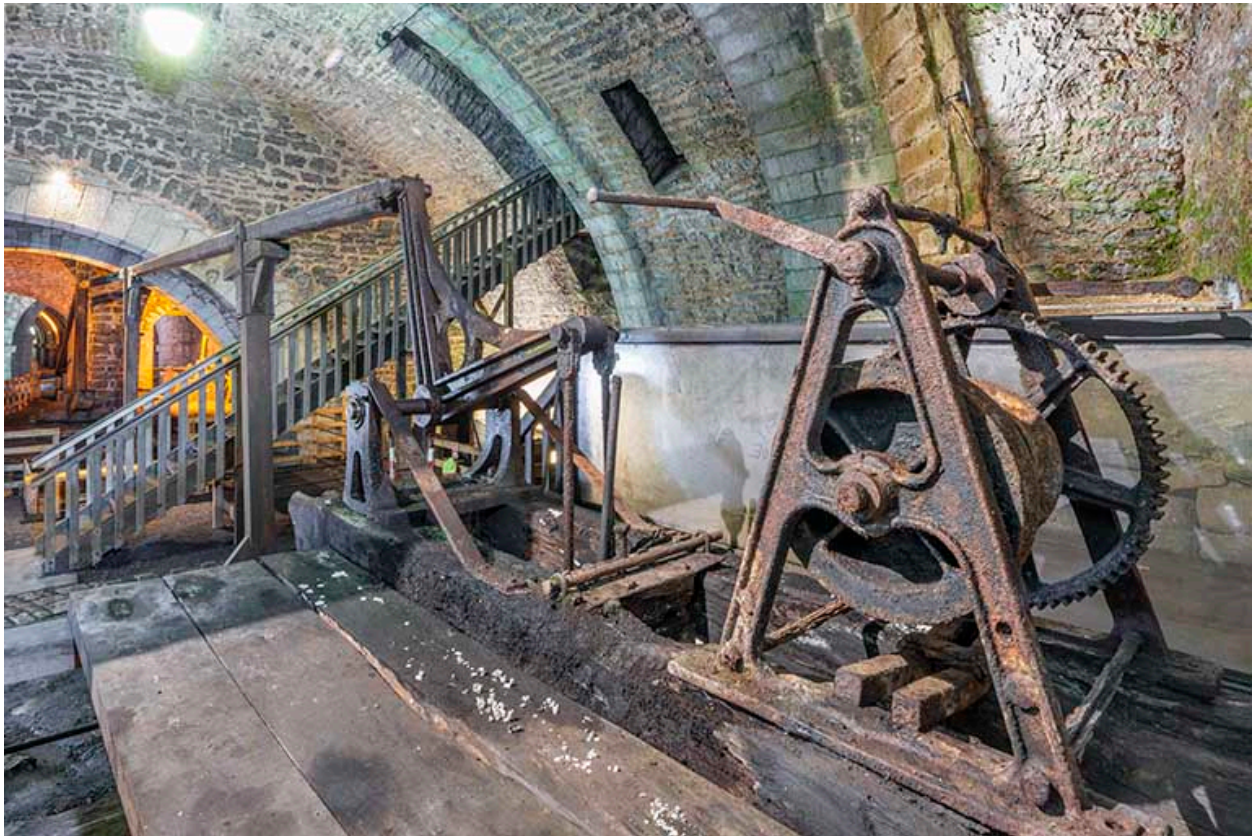
Tête de puits du sondage et treuil de relevage (hors service).
