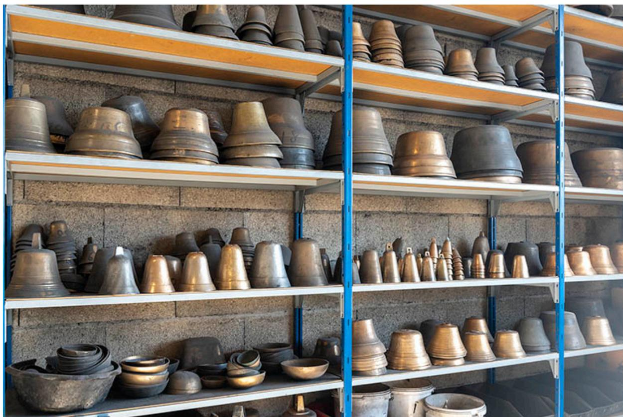
Fabrication du moule : les modèles.
