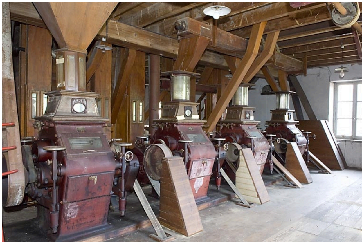
Premier étage. Appareils à cylindres doubles L. Michel - Simonis.
