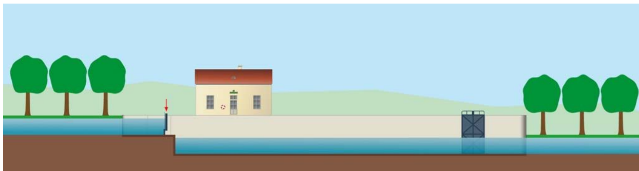
Schéma d'éclusage d'un bateau montant, étape 1.
