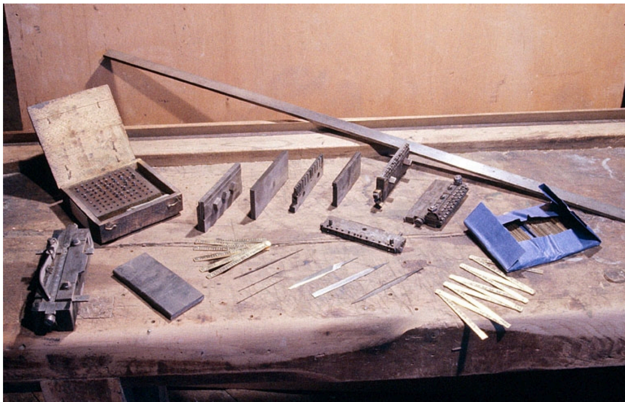
Poinçons, mètre-étalon et mètres pliants.
