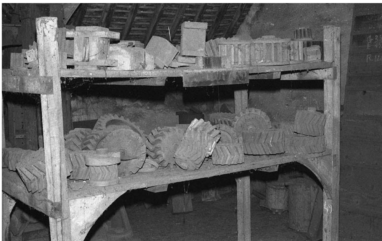
Modèles d'engrenages en bois.
