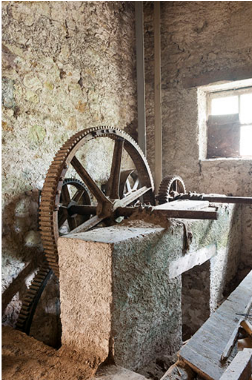
Système de transmission annexe par engrenages (scie circulaire ?).
