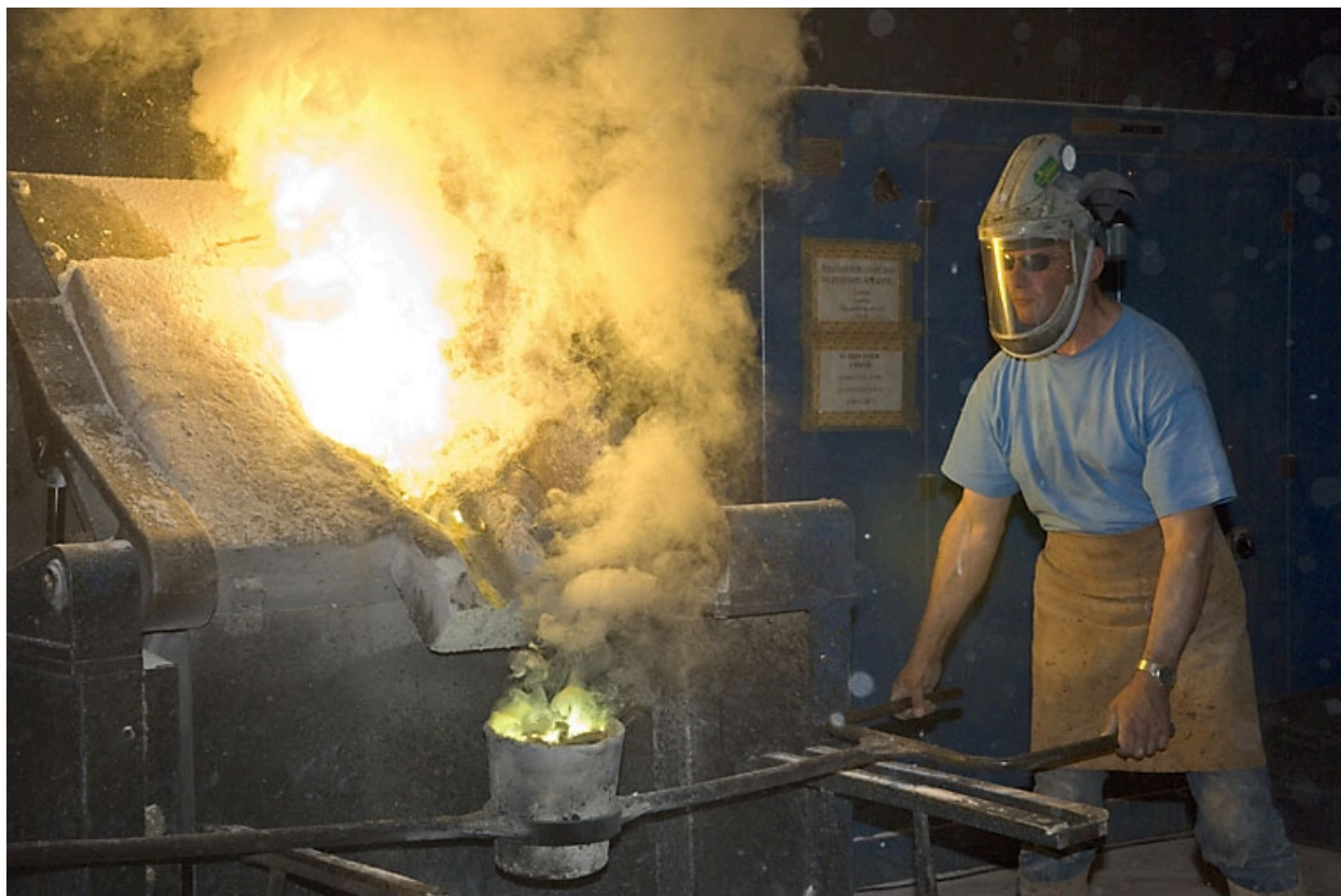
Fonderie de Saint-Sauveur et ateliers municipaux : transport de la poche de bronze.
