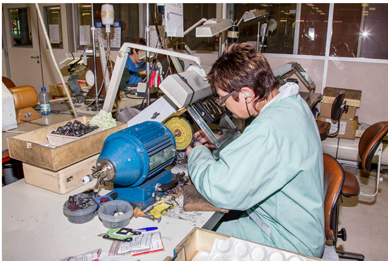
Atelier de polissage : polissage d'une alliance.
