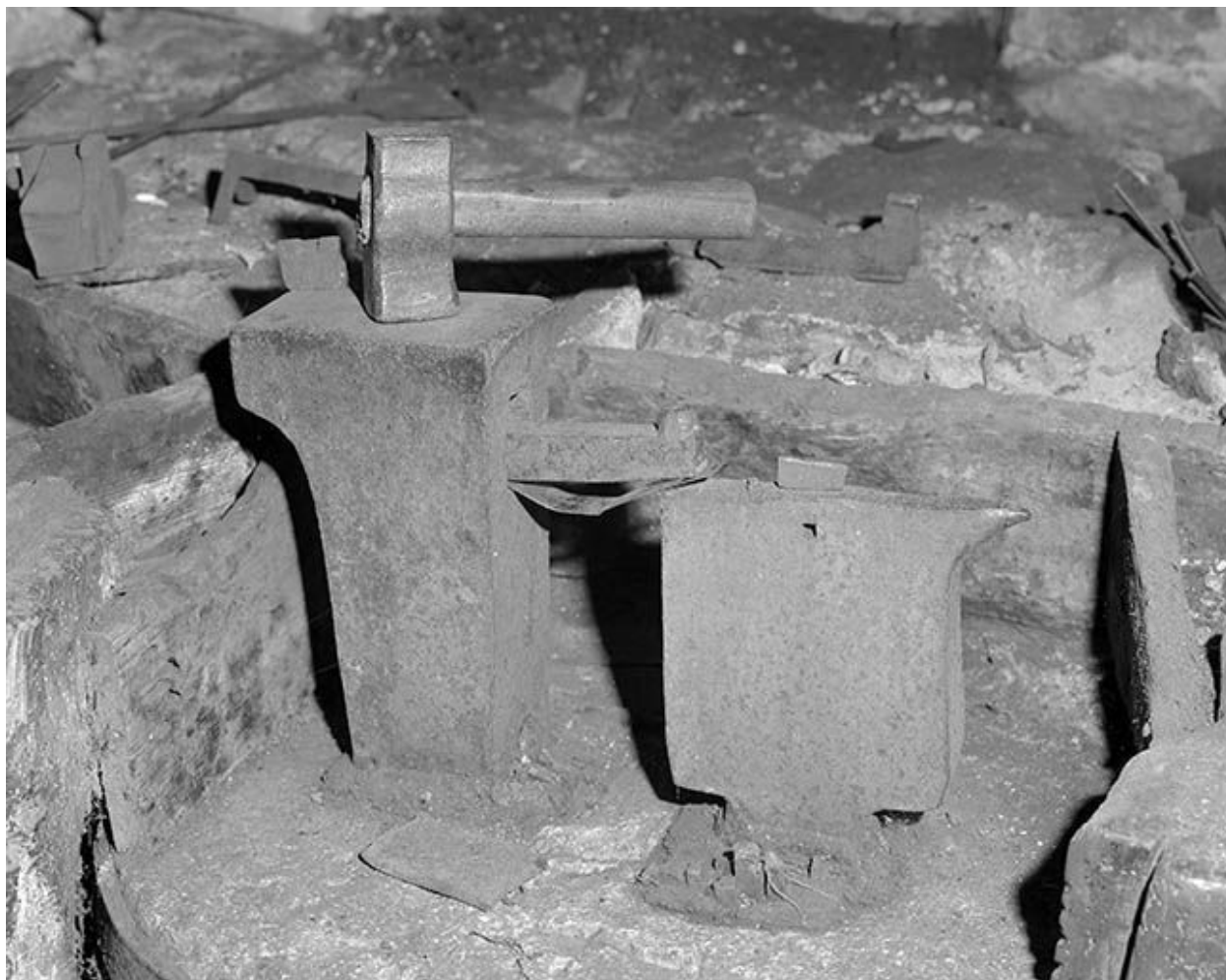
Poste de travail équipé avec la matrice pour les clous.
